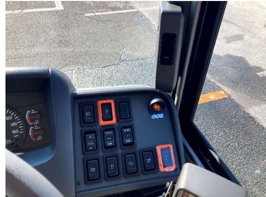
新造車 6 両中 2 両の EDSS がドライバー 異常自動検知システム (DSM) 付き
